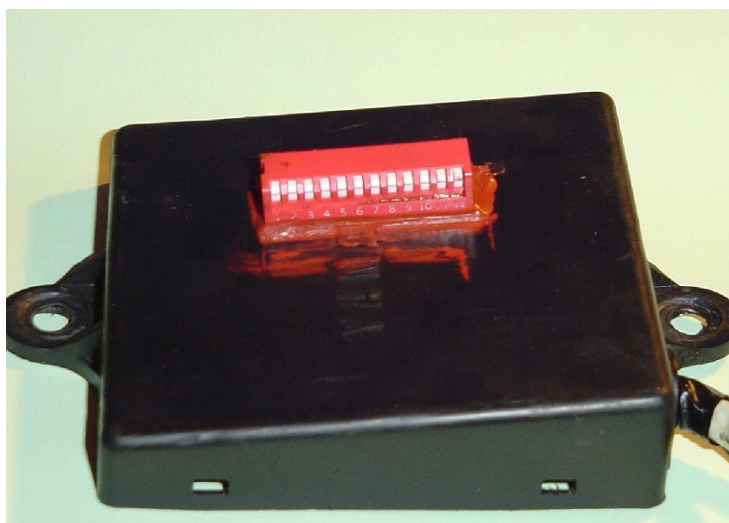
PV-Box 1WW auf DIP-Schalter umgebaut.
